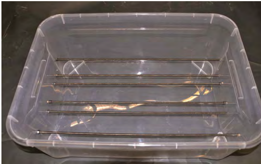
Abbildung 24: Kunststoffwanne mit eingedrehten Gewindestäben zur Lagerung der Probekörper.
