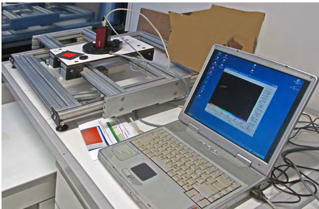
Abbildung 33: Anlage der Firma Walz, Typ IMAG- C; S/N: IKEA0130; Kamera Modell: IMAG-K. im Labor der Hochschule Wismar zur Messung der Fluoreszenzquantenausbeute durch die Puls-Amplitudenmodulierten Fotometrie (PAM).
