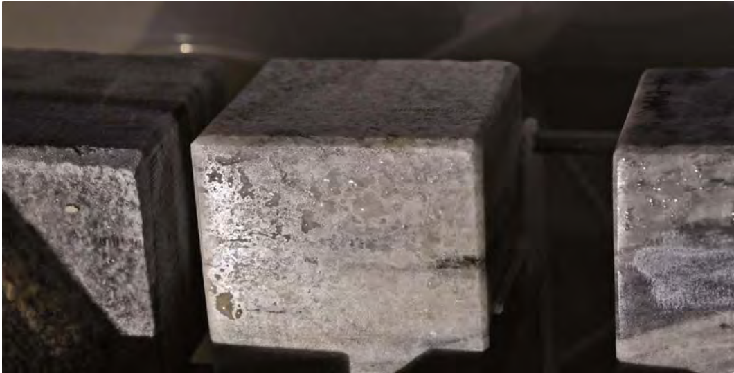
Abbildung 54: Stationär verbleibende Wassertropfen auf hydrophobierten Natursteinoberflächen.
