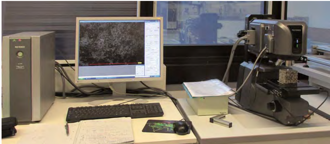
Abbildung 28: Laserscanmikroskop der Firma Keyence, VK 9710, mit Software unterstützter Auswertung am PC.
