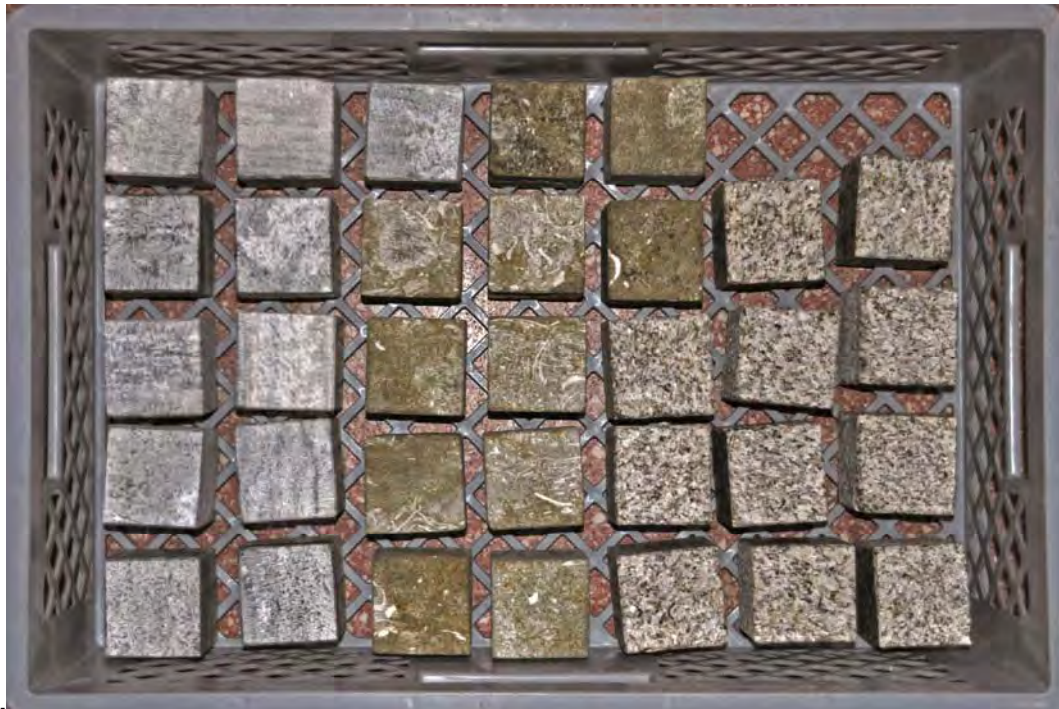
Abbildung 22: Gefertigte Natursteinwürfel als Probekörper: Links Wunsiedler Marmor, mittig Ihrlersteiner Grünsandstein und rechts Epprechtstein-Granit.
