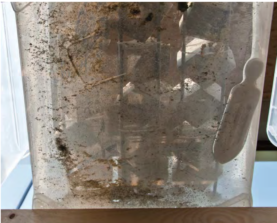
Abbildung 27: Substrateinlagerung über die Atmosphäre in einer Klimawanne.
