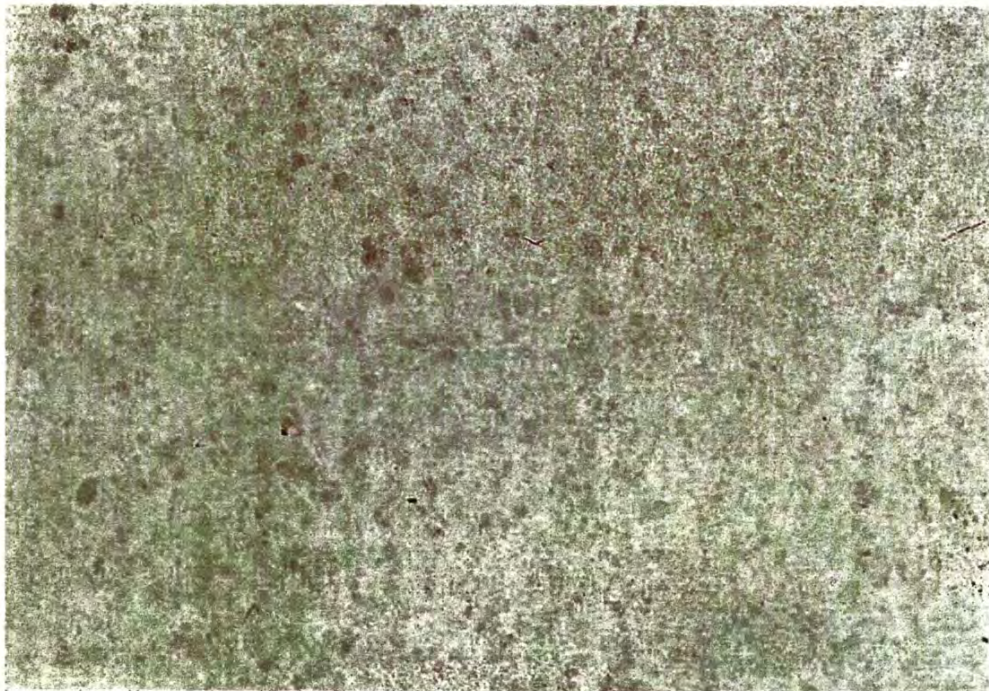
Abbildung 14: Wunsiedeler Marmor mit deutlich erkennbaren Calcit-Kristallen und Tönungen vermutlich durch Einlagerungen von Olivin und Serpentin.
