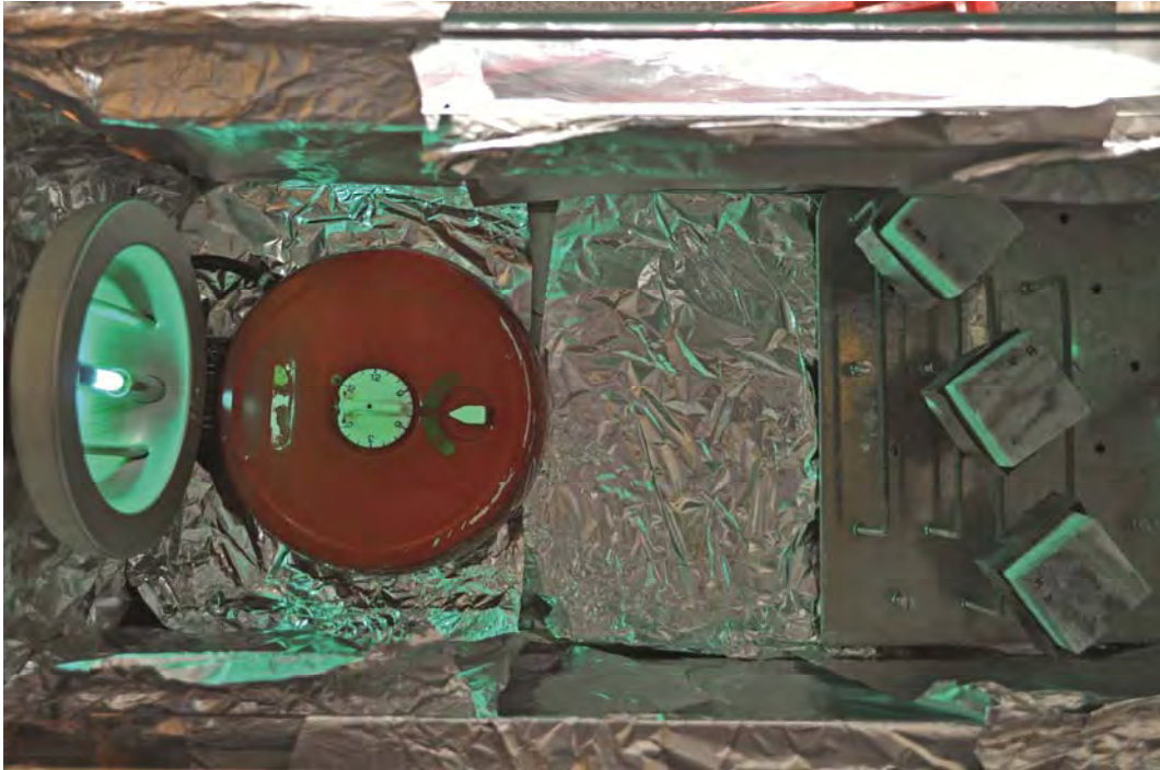
Abbildung 32: Versuchsanordnung zur künstlichen Alterung durch eine intensive UV-Bestrahlung. Quarzlampe und frei aufgestellte Probekörper.
