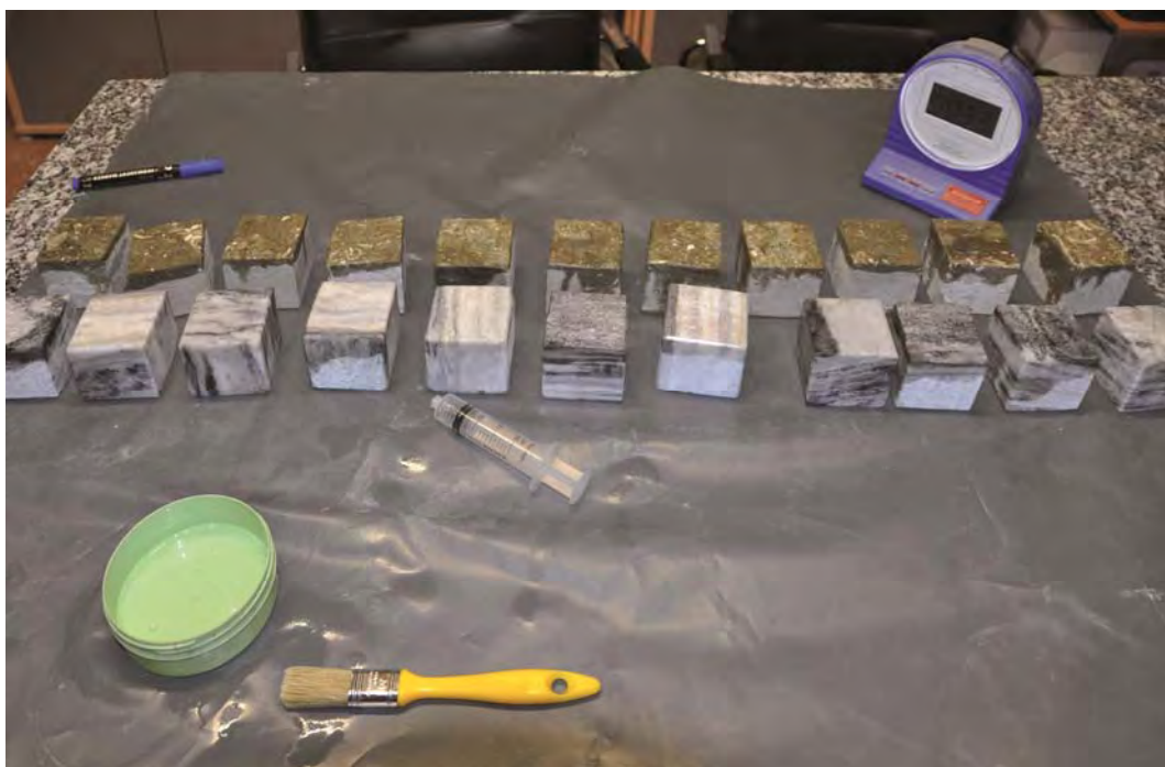
Abbildung 23: Applikation der Hydrophobierungsstoffe bis zur Sättigung innerhalb max. 5 Minuten pro Fläche.
