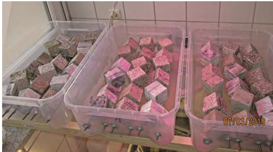
Abbildung 25: Probekörper in geöffneter Wanne mit zusätzlicher UV-Beleuchtung.
