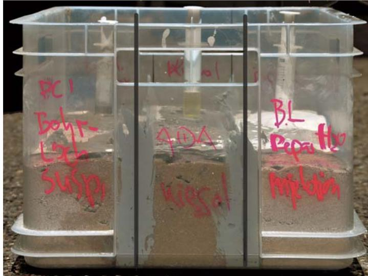
Abb. 48: Nur beim Kiesol-Injektionsmittel ist eine Durchfeuchtung des Faches festzustellen.
