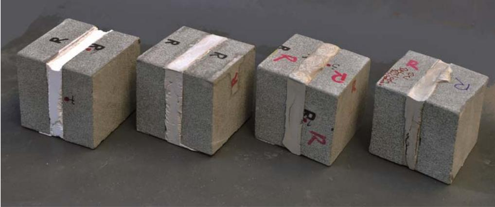
Abb. 45: Verfüllung der Sandwiches mit zementären Produkten: zwei Injektionsmörtel sacken ab.
