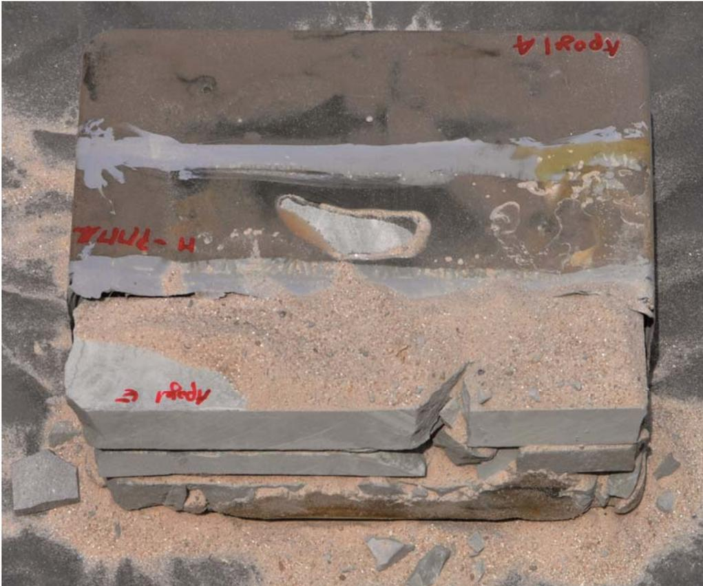
Abbildung 52: Umgestülpte, geleerte Plastikwanne mit verfüllten Fächern von Reaktionsharzen: Die beiden hinteren bilden ganze Körper aus. Dem PU-Harz im Vordergrund gelingt dies nicht: (Ansicht von unten).
