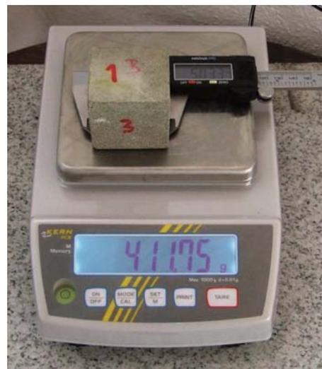
Abb. 54: Messaufbau zur Bestimmung der Rohdichte: Waage und Schublehre
