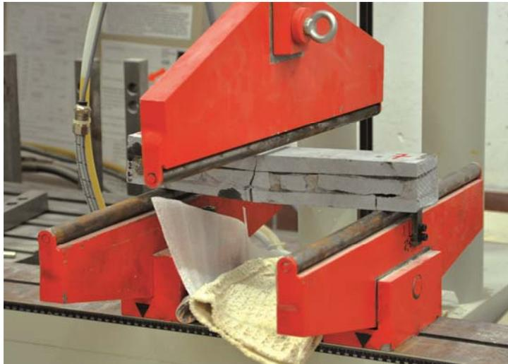
Abb. 57: Biegezugtest durch mittige Auflast eines Schneidestempels über zwei Rundauflager
