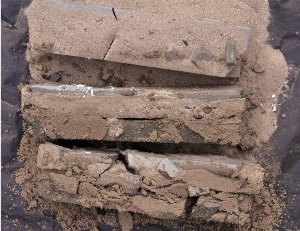
Abb. 49: Nach dem Öffnen der Fächer mit anorganisch verfüllten Injektionsmittel fallen die Materialien auseinander.
