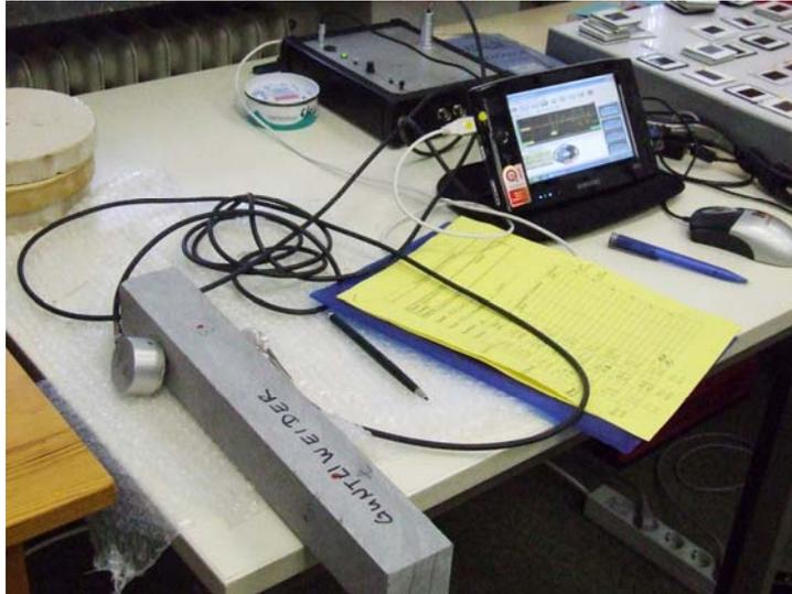
Abb. 55: Messung des dyn. E-Moduls am Sandsteinprisma über Schallgeer und -Empfänger
