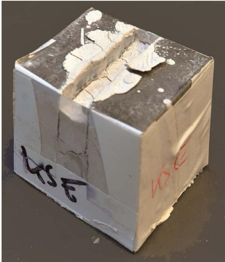
Abb. 44: Verfüllung eines Sandwich mit KSE-Mörtel: deutlich ist das Absaugen des KSE und das Absacken des Füllstoffes zu sehen.
