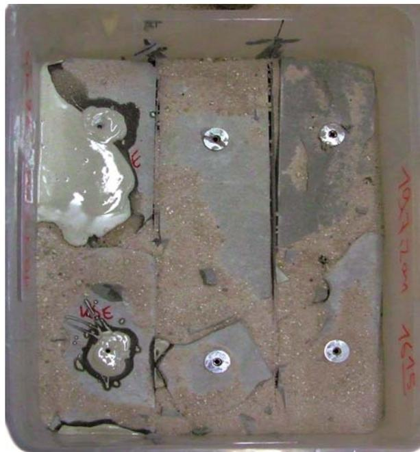
Abb. 40: Verfüllen eines Faches mit mineralischen Injektionsmaterial. (Ansicht von oben)
