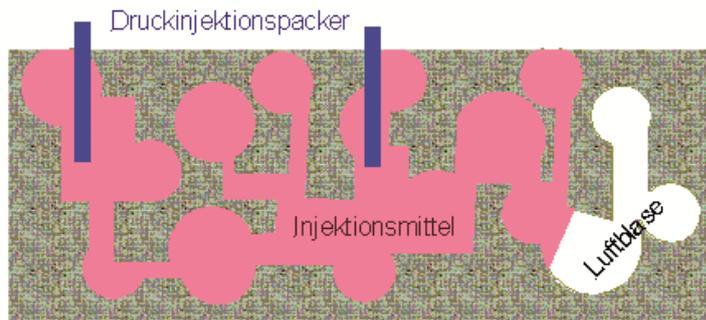
Abb. 32: Blasenbildung bei nicht entlüftender Druckinjektion
