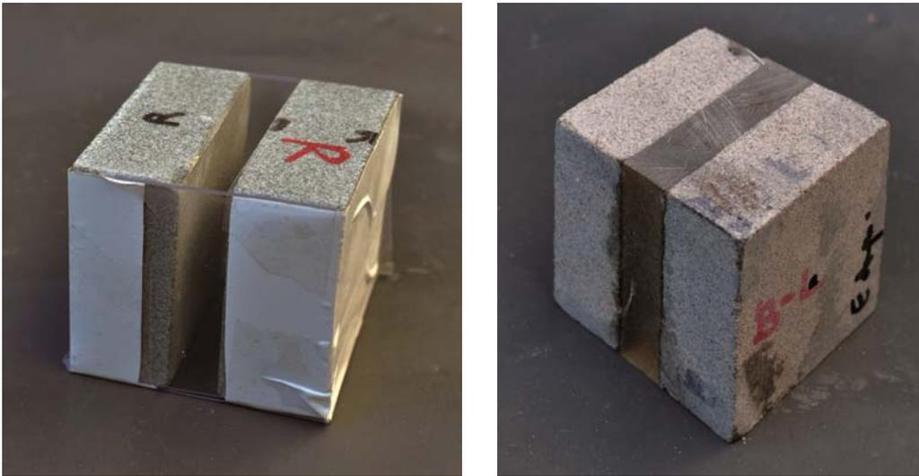
Abb. 36: Sandwich-Körper: links leer und rechts verfüllt und überschliffen
