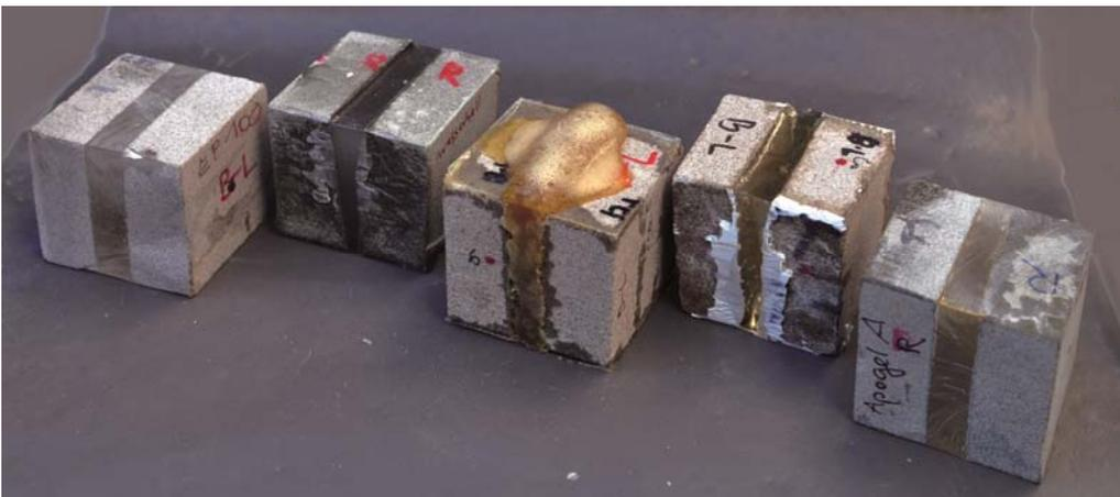
Abb. 46: Injektionsharze. das PU-Harz quillt zwischen den Scheiben hervor. Bedingt durch kapillares Saugen bilden sich bei den anderen kleine Minisken.
