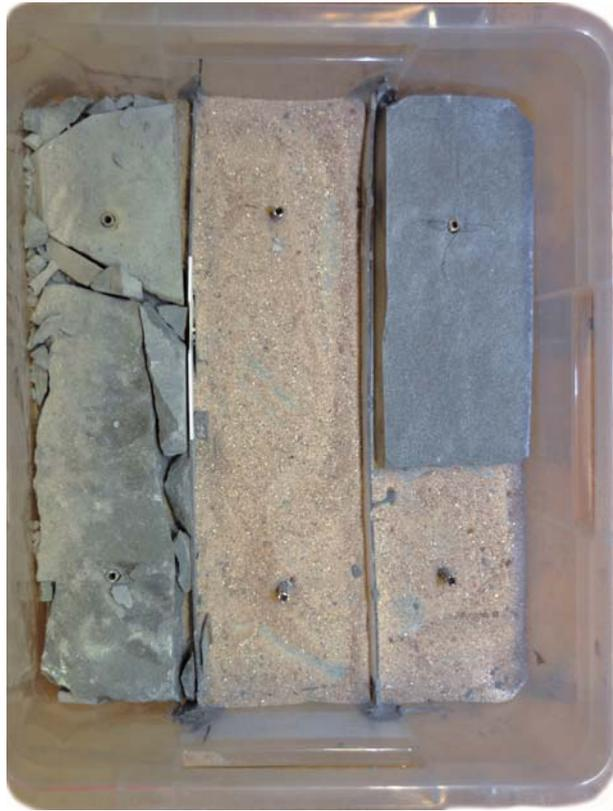
Abb. 39: Einschichten der Materialien für den "Chaosverbundkörper": zu sehen sind links: Scherben, mittig Quarzsand und rechts wieder Scherben. Deutlich erkennbar sind die Injektionshülsen. (Ansicht von oben)
