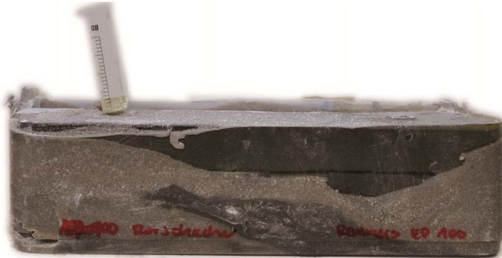
Abbildung 51: Nahezu voll ständig verfülltes Fach mit einem "Glaskörper" aus Harz und Stein und Quarzsand
