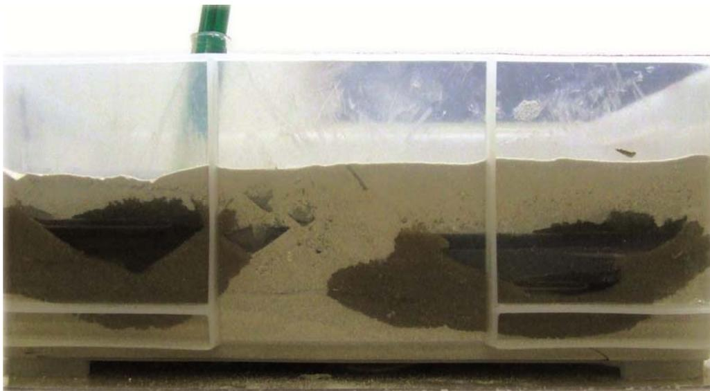
Abbildung 50: Beim Injizieren breitet sich das Harz von den Injektionshülsen aus (dunkle Flecken).
